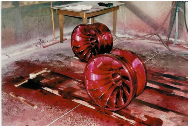
Fig. 4. Roues Francis en atelier durant les essais de réception non destructifs.
