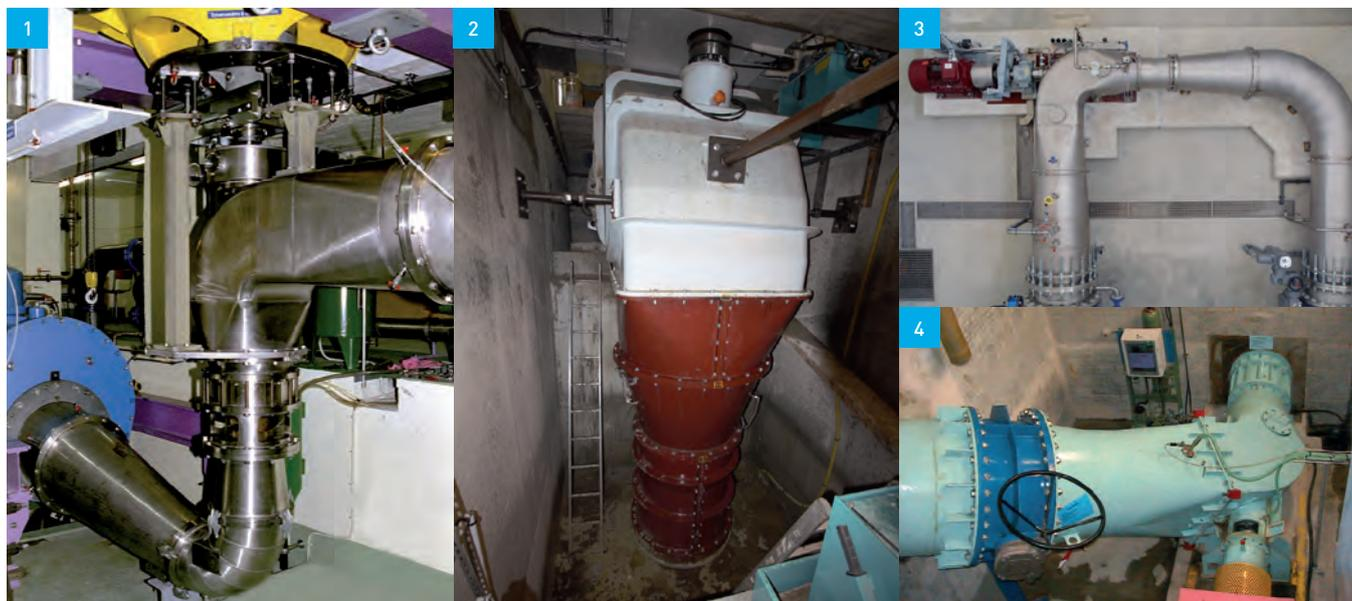
1 Turbine axiale sur le stand d'essais Mhyllab, à axe vertical
