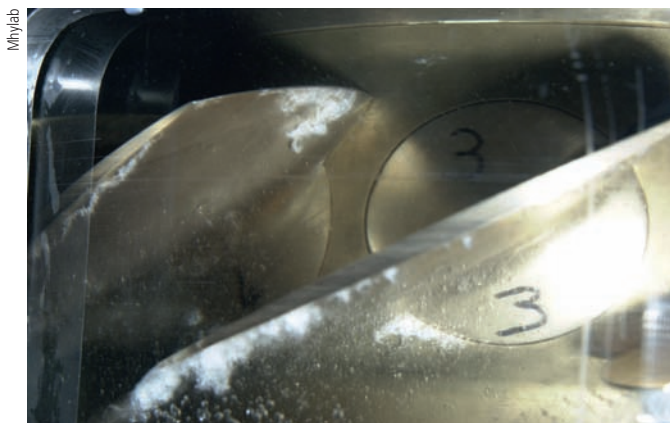
Figure 10 Cavitation jugée dommageable sur une pale de turbine Kaplan.
