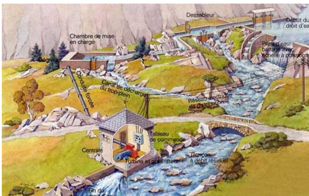
Figure 1. Représentation de tous les équipements pouvant composer un aménagement de petite hydraulique
