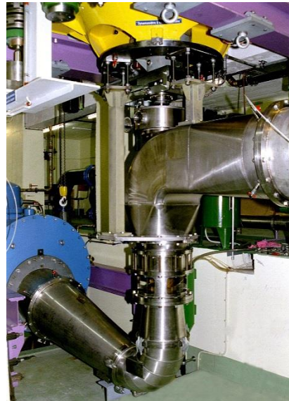
Figure 5 : Modèle réduit de la turbine Axiale en S de type de Kaplan sur le stand d'essais (© Mhylab)
