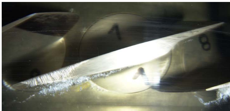
Figure 1. Observation du phénomène de cavitation sur une turbine 8 pales équipées de collerettes, sur le banc d'essais MHyLab
