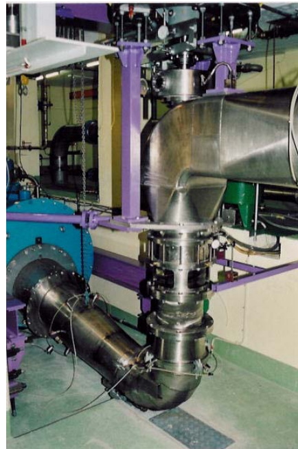
Figure 12 : Vue du banc d'essai MHyLab
