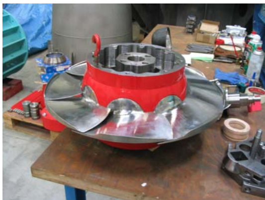
Figure 7. Nouveau groupe axial de st-Bueil: roue à 8 pales
