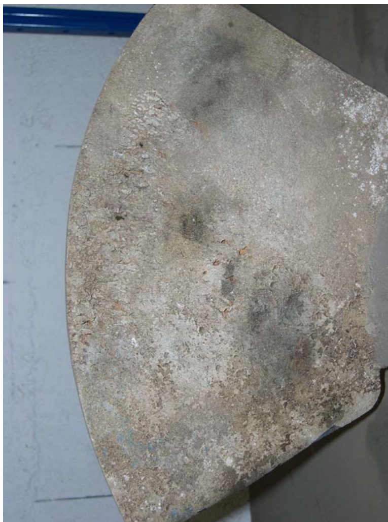
Pale érodée par la cavitation
