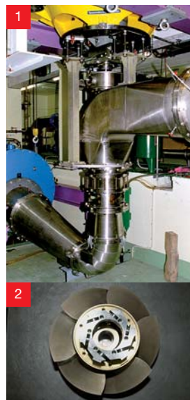
1 Stand d'essais MHyLab équipé du modèle réduit de la turbine Axiale 2 Modèle réduit du laboratoire : roue axiale à 6 pales
